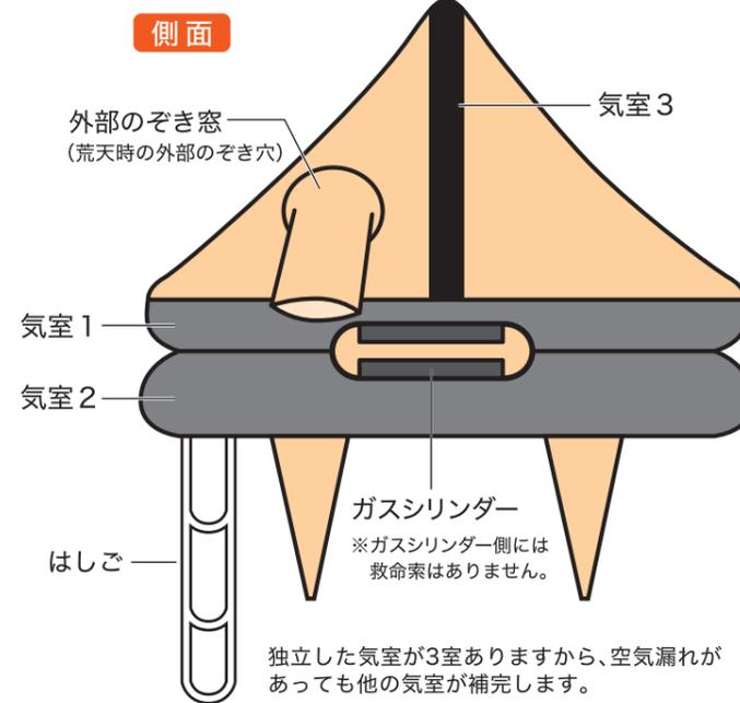
独立した気室が3室ありますから、空気漏れがあっても他の気室が補完します。
