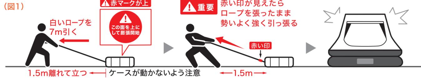
ガスが注入されると、シューッという音がし、15~20秒でケースが自動的に開き、透明のビニール広巾バンドで覆われた本体がケースの中から出てきます。本体が膨張をつづけ、ビニールカバーが破れますが、もし本体がケースから出てきてすぐにビニールカバーが破れなかった時は、ただちに手でビニールカバーを破り膨張動作の手助けをして下さい。2分程でシューッという音がしなくなったら、ガスが全て注入され、搭乗できるようになりますが、もしふくらみが充分でない場合は、いかだ室内にある3ヶ所の空気注入口から、それぞれの気室(カノピー:天蓋を支える支柱気室・いかだ本体の上部気室・下部気室)へ備品の空気ポンプで空気を注入します。使用が長期間になった時も、気室の空気は自然減少しますから、適宜空気を補充して下さい。又温度が下がると、いかだの素材が収縮し、わずかながら空気が減少しますから、空気ポンプで、空気を注入して下さい。
