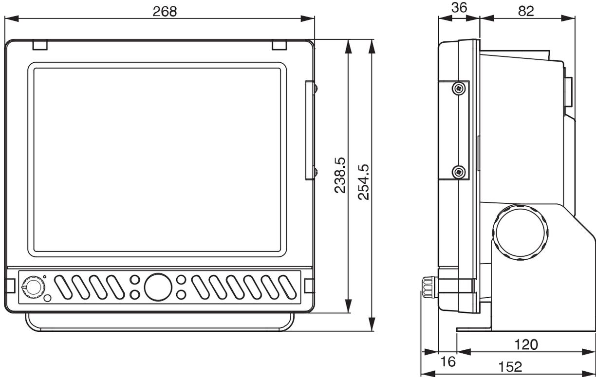
＜架台取付け穴寸法図 10.4 型＞ (HE-730S)
