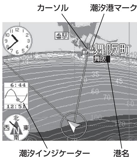
**2** メニューから「6. 表示設定」→「7. 潮汐インジケータ」→「2. 潮汐インジケータ港選択」を選択し、〔方向〕キーの◀ ▶（左・右）で“手動”を選択します。
