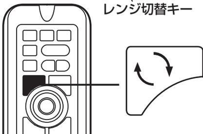
〔0〕キーをレンジ切替として設定しておく、よく使うレンジをワンタッチで切り替えることができます。レンジは2つまで設定でき、〔0〕キーを押して切り替えます。
