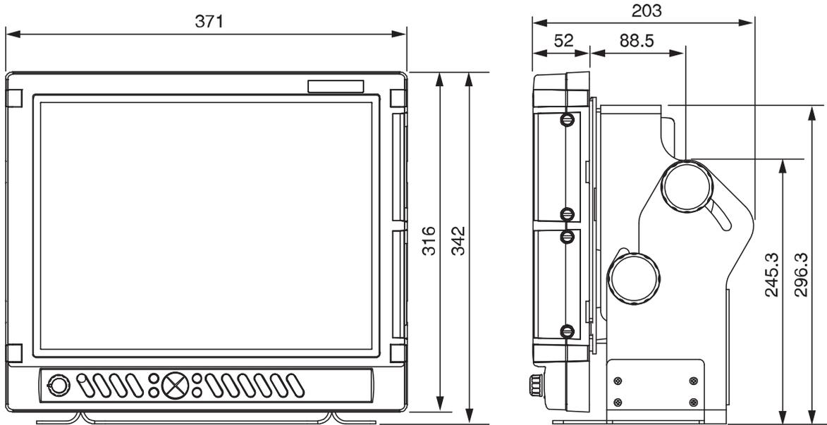
＜架台取付け穴寸法図 15型＞【HE-151S、HE-152S】
