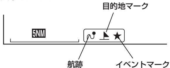
**2** 航跡記録中に〔航跡 ON/OFF〕キーを押すと、記録を中断します。画面左下の“∩”は消えます。
