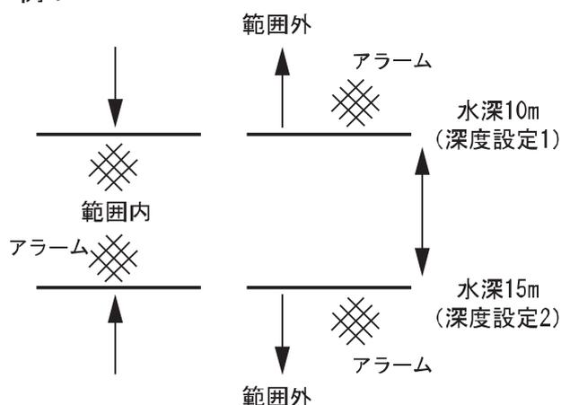
※水深が設定した深度に達すると、水深が赤⇔白で点滅し、アラームが鳴ります。アラームが鳴っている状態で〔取消〕キーを押すと、アラームが鳴り止みます。
