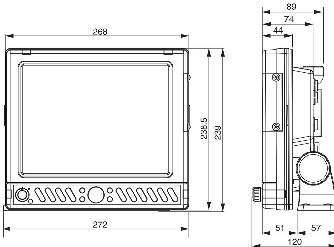
＜架台取付け穴寸法図 10.4 型＞ [HE-732S]
