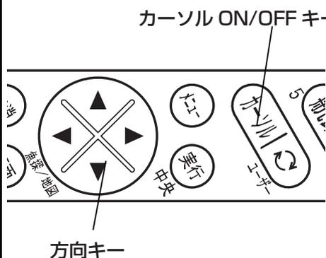
**1** 魚探または魚探+プロッター画面で〔カーソル ON/OFF〕キーを長押しします。
